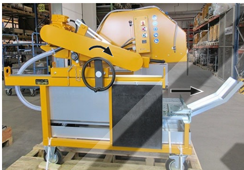
Pjovimo vežimėlį rankiniu ratu judinkite į priekį iki atramos pav. 4.15
