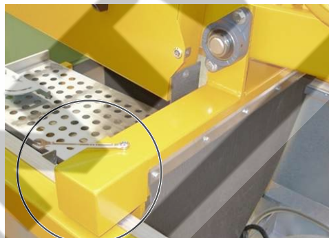
90° kampas (horizontaliai), patikrinti atraminio stalo ir pjovimo disko kampą pav. 5.3
