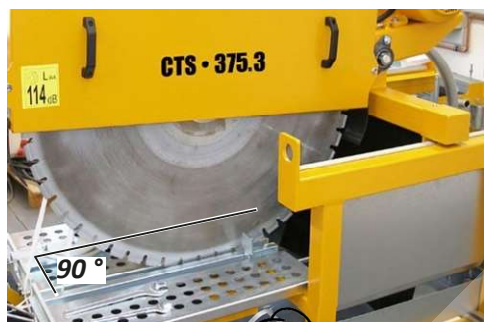
90° kampas (horizontaliai), patikrinti atraminio stalo ir pjovimo disko kampą pav. 5.3
