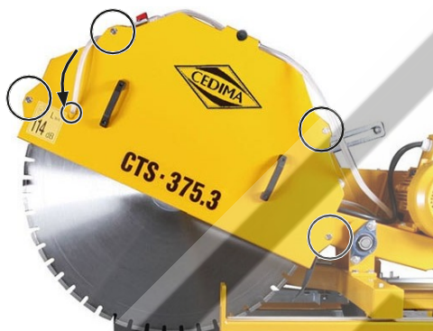
Užkabinti pjovimo disko apsauginį gaubtą ir pritvirtinti įstatyti vandens žarną į pjovimo disko apsauginį gaubtą 4.27 pav.
