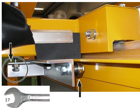
Varžtas su fiksavimo veržle padavimo jėgai reguliuoti (vairuojamųjų ratukų spaudimo jėga) 5.9 pav.
