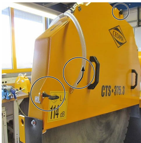
Kvadratinį veržliarakčių atsukti ir (arba) užsukti pjovimo disko apsauginį gaubtą; Ištraukti vandens žarną iš pjovimo disko apsauginio gaubto 4.19 pav.
