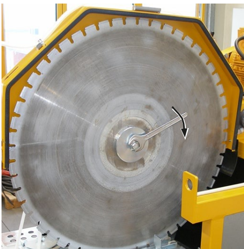
Slėgio flanšo su pjovimo veleno veržle tvirtinimas prie deimantinio pjovimo disko 4.25 pav.
