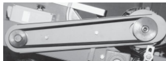
Pav. 4.10. Trapecinių diržų apsauginis gaubtas nuimtas
