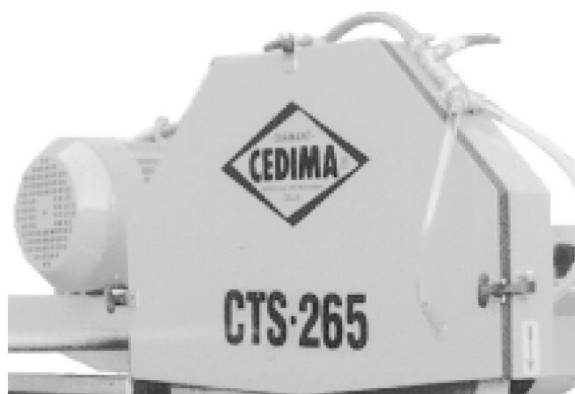
Pav. 4.11. Pjovimo disko apsauginio gaubto dangtis sumontuotas
