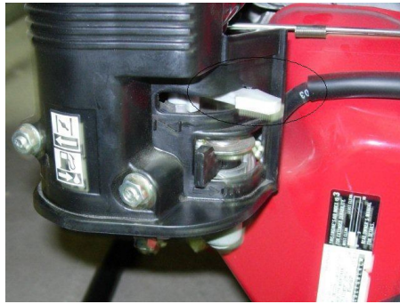
Droselio reguliatorius padėtyje RUN – generatoriams SP2-6H ir TP5-9H.
