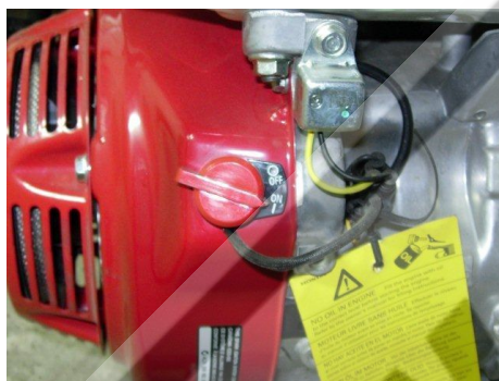
STOP jungiklis padėtyje ON (įjungtas) – generatoriams su Honda varikliais
