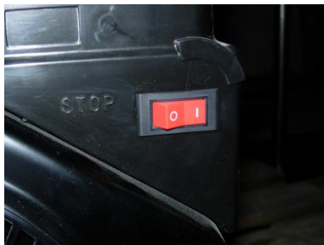
STOP jungiklis padėtyje ON (įjungtas) – generatoriams su Vanguard varikliais
