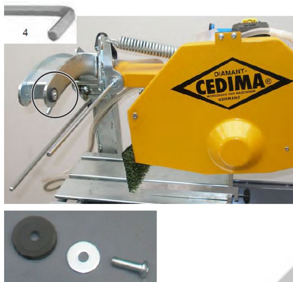
Pav. 5.8. Galinė atrama (viršuje); pjovimo diskas ir apsauginė užuolaida išmontuota
