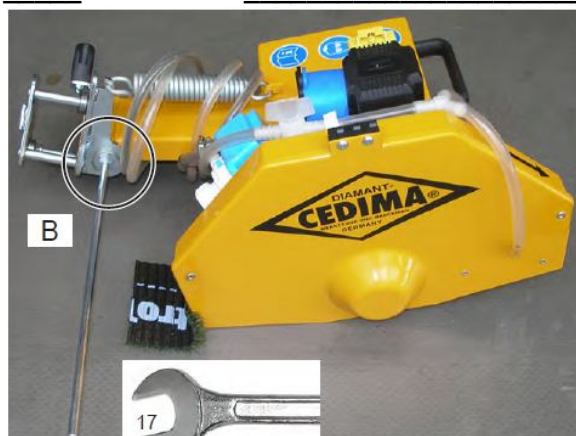
Pav. 5.22. Išmontuoti apsauginės užuolaidos laikiklį su fiksavimo veržle ir poveržle
