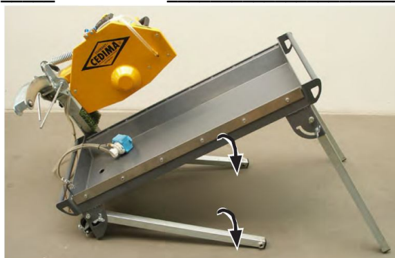
Pav. 4.10. Antrą stalo kojų porą atlaisvinti ir atlenkti
