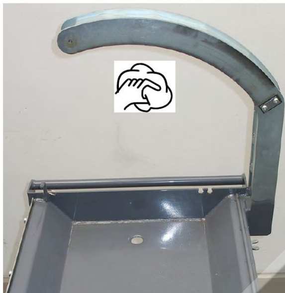
Pav. 5.12. Kreipiantysis slankiklis su svyruojamuoju pjovimo svertu ir vandens siurbliu išmontuoti
