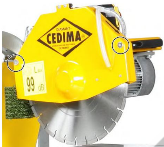
Pav. 4.32. Užvožti pjovimo disko apsauginį gaubtą ir prisukti veržles
