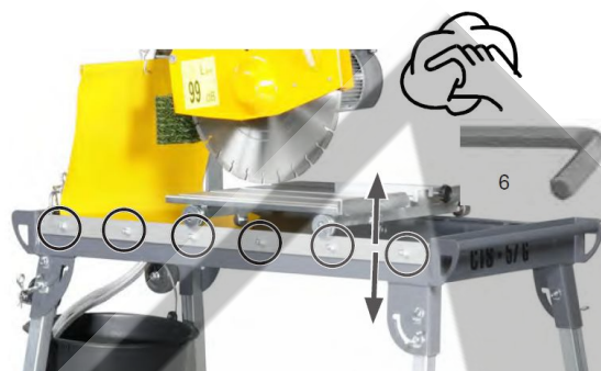
Pav. 5.2. Ištiesinti stalo su ratukais kreipiančiąją liniuotę
