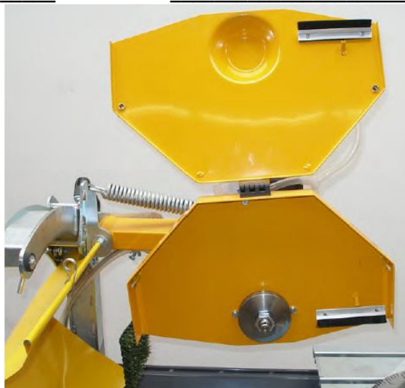
Pav. 4.25. Atvožti pjovimo disko apsauginio gaubto dangtį
