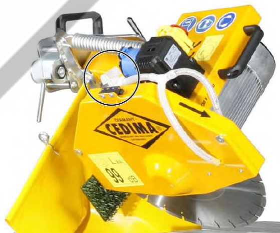
Pav. 4.22. Abipusinis aušinimo vandens tiekimas ant pjovimo disko apsauginio gaubto bepakopiai reguliuojamas čiaupu
