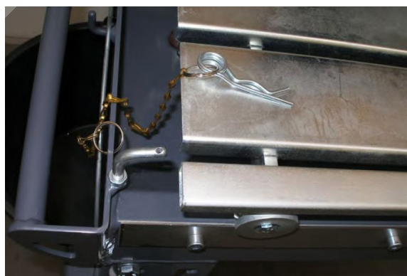
Pav. 4.2. Stalo su ratukais transportavimo fiksatorius nuimtas
