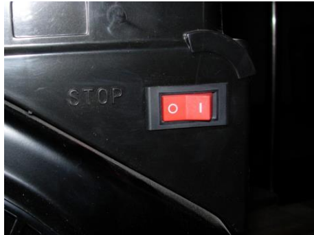
STOP jungiklis padėtyje OFF (išjungtas) – generatoriams SP3-12V, TP5-15V.
