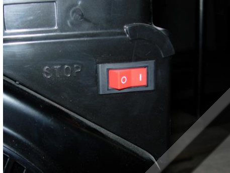
STOP jungiklis padėtyje ON (įjungtas) – generatoriams SP3-12V, TP5-15V.
