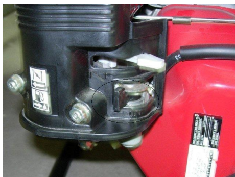
Kuro vožtuvas padėtyje OFF (uždarytas) – generatoriams SP2-6H, TP5-7H.
