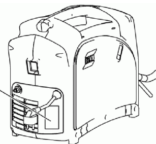
Merkeplate med tilkoplingsdata
